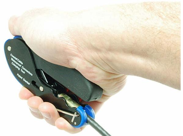
**STEP 10:** SQUEEZE THE COMPRESSION TOOL UNTIL THE RATCHETING HANDLES RELEASE.
