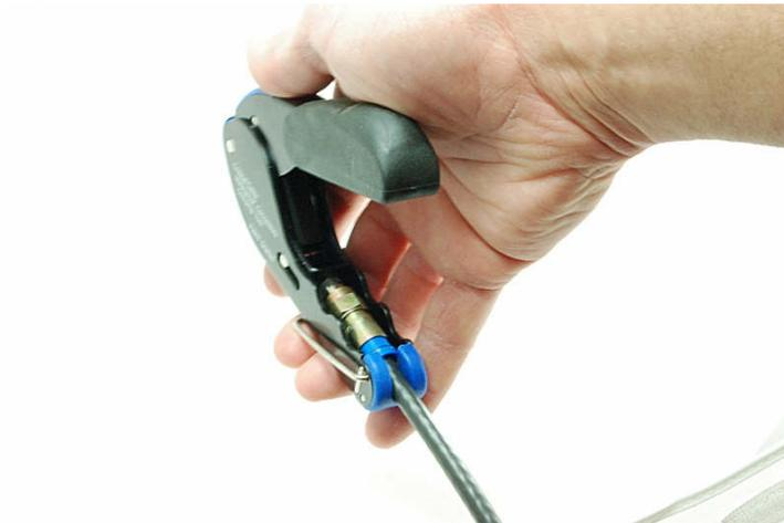
**STEP 9:** INSERT THE COMPRESSION CONNECTOR INTO THE COMPRESSION TOOL AS SHOWN SO THAT THE CONNECTOR IS SQUARE WITH THE MOUTH OF THE TOOL.
