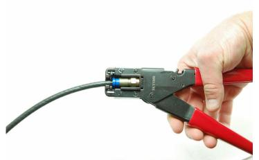
**STEP 9:** INSERT THE COMPRESSION CONNECTOR INTO THE COMPRESSION TOOL AS SHOWN SO THAT THE CONNECTOR IS SQUARE WITH THE MOUTH OF THE TOOL.
