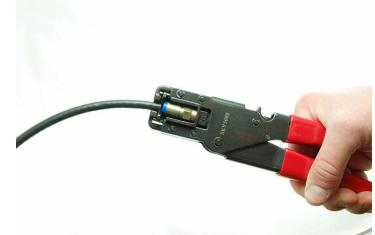
**STEP 10:** SQUEEZE THE COMPRESSION TOOL UNTIL THE RATCHETING HANDLES RELEASE.
