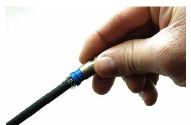
**STEP 7:** INSTALL COMPRESSION CONNECTOR ONTO THE PREPARED CABLE END.
