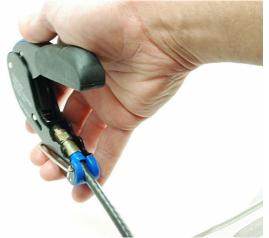
**STEP 9:** INSERT THE COMPRESSION CONNECTOR INTO THE COMPRESSION TOOL AS SHOWN SO THAT THE CONNECTOR IS SQUARE WITH THE MOUTH OF THE TOOL.
