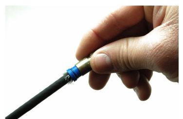
**STEP 7:** INSTALL COMPRESSION CONNECTOR ONTO THE PREPARED CABLE END.
